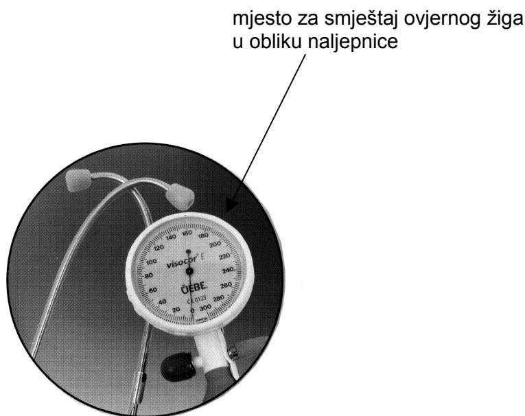
Slika 1: Fotografija tlakomjera tip Visocor E s prikazom mjesta za smještaj ovjerne naljepnice
